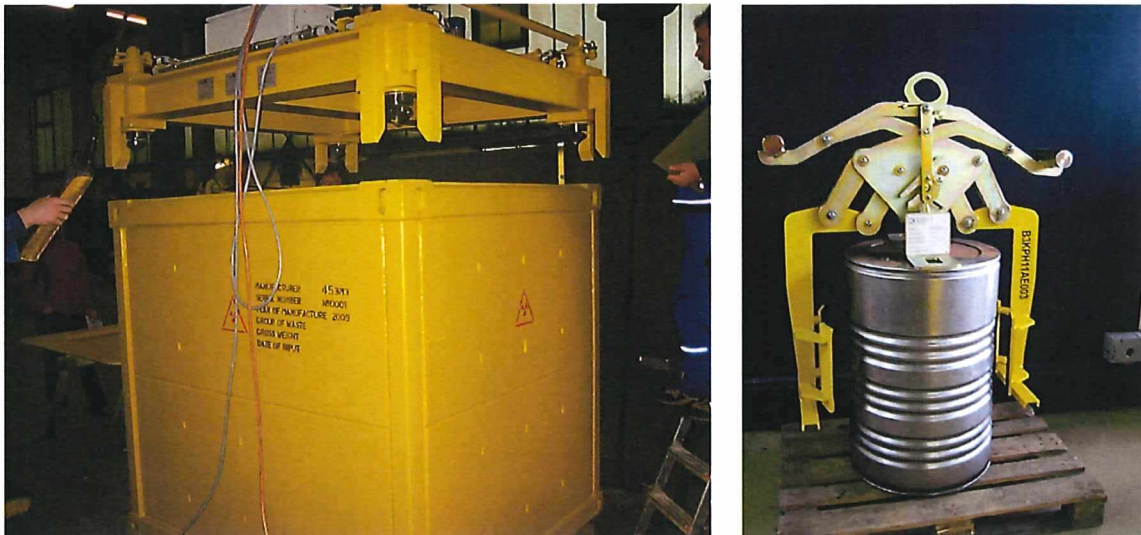
Abb. 24: Beispiele für Manipulatoren. Links: Greifer für G3 Abfallcontainer (hochaktive Abfälle), Lifting Cap. 8800kg. Rechts: Mechanischer Fassgreifer für 165 Liter Pressfass.
