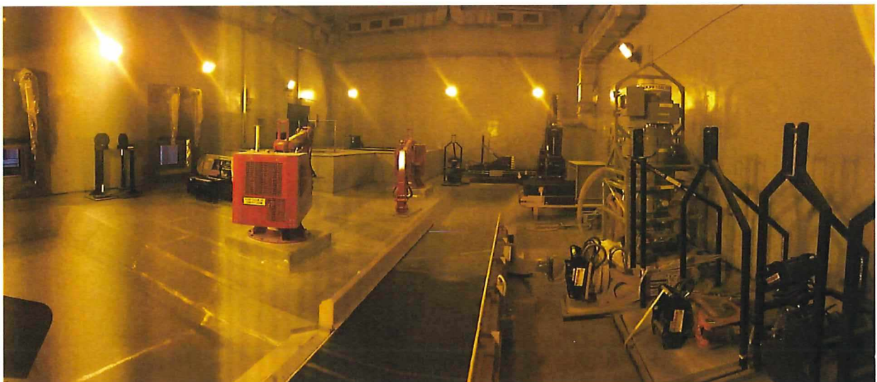
Abb. 22: Beispiel für eine Heiße Zelle mit 2 Strahlenschutzfenstern, 2 Gelenkmanipulatorpaaren, 2 Kraftmanipulatoren mit entsprechendem Werkzeug, 1 Standsauggerät und weiteren Bearbeitungseinrichtungen.
