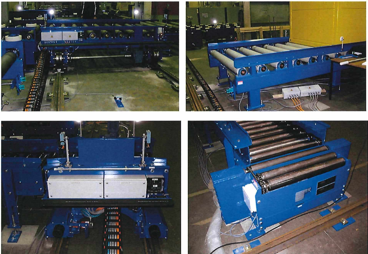
Abb. 19: Beispiele für Transportmittel innerhalb der Abfallbehandlungsanlage. Oben links: Transferwagen mit Rollenbahnsegment für Container. Oben rechts: Rollenbahnsegment für Container, Übergabe zu Transferwagen. Unten links: Transferwagen mit Rollenbahnsegment für Fasstransport. Unten rechts: Rollenbahnsegment für Fasstransport, Übergabe zu Transferwagen.
